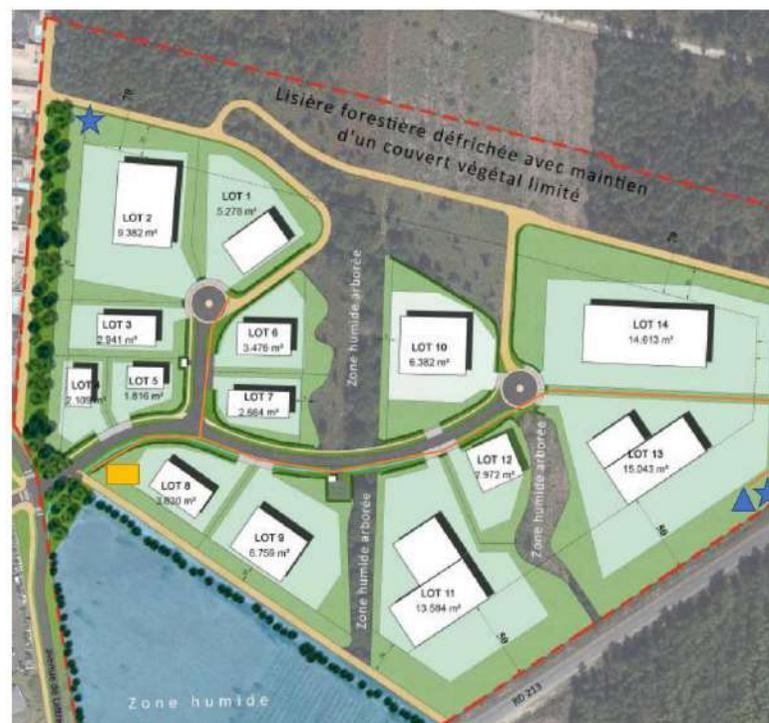
Proposition d'implantation des deux forages ★, de la centrale d'énergie ▲ et de la station multi-énergies ■ et des réseaux de chaleur et de froid — avec 50% des surfaces de toitures équipées de panneaux solaires
