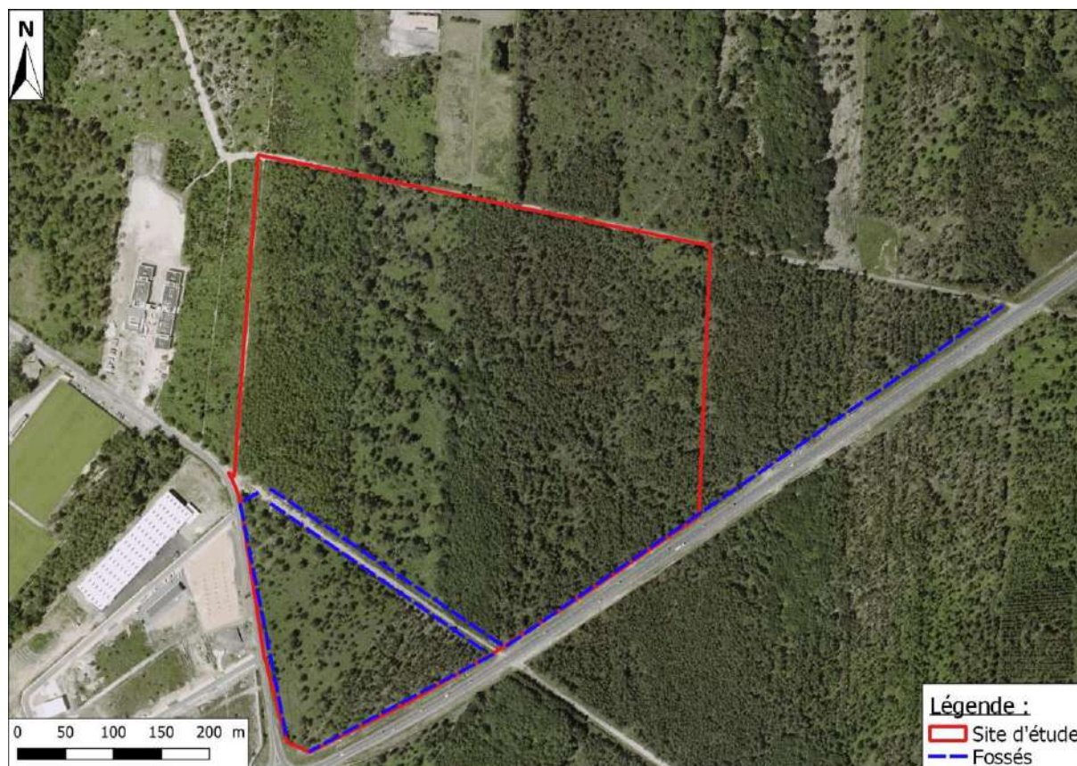
Figure 10 : Réseau de fossés aux abords de la zone d'étude (Source : BD ORTHO Métropole, Réalisation : CERAG)
