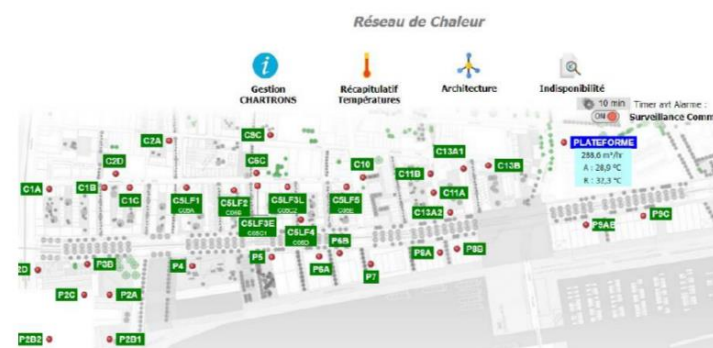
Image-écran de supervision d'un réseau de chaleur
