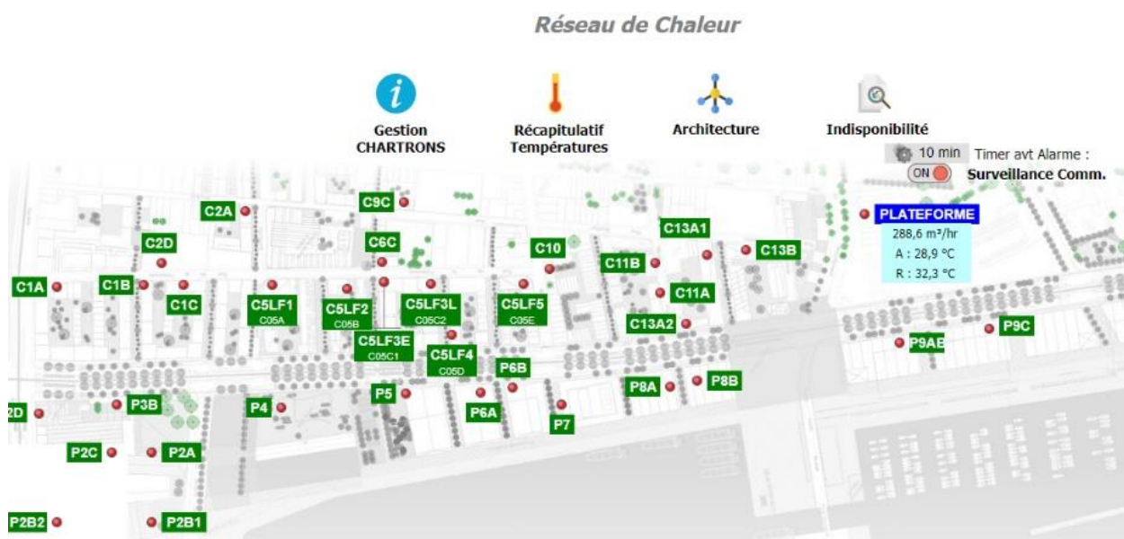
Image-écran de supervision d'un réseau de chaleur
