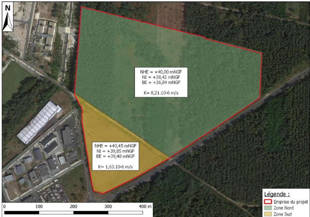
**Figure 68: Plan de zonage des coefficients de perméabilité**
