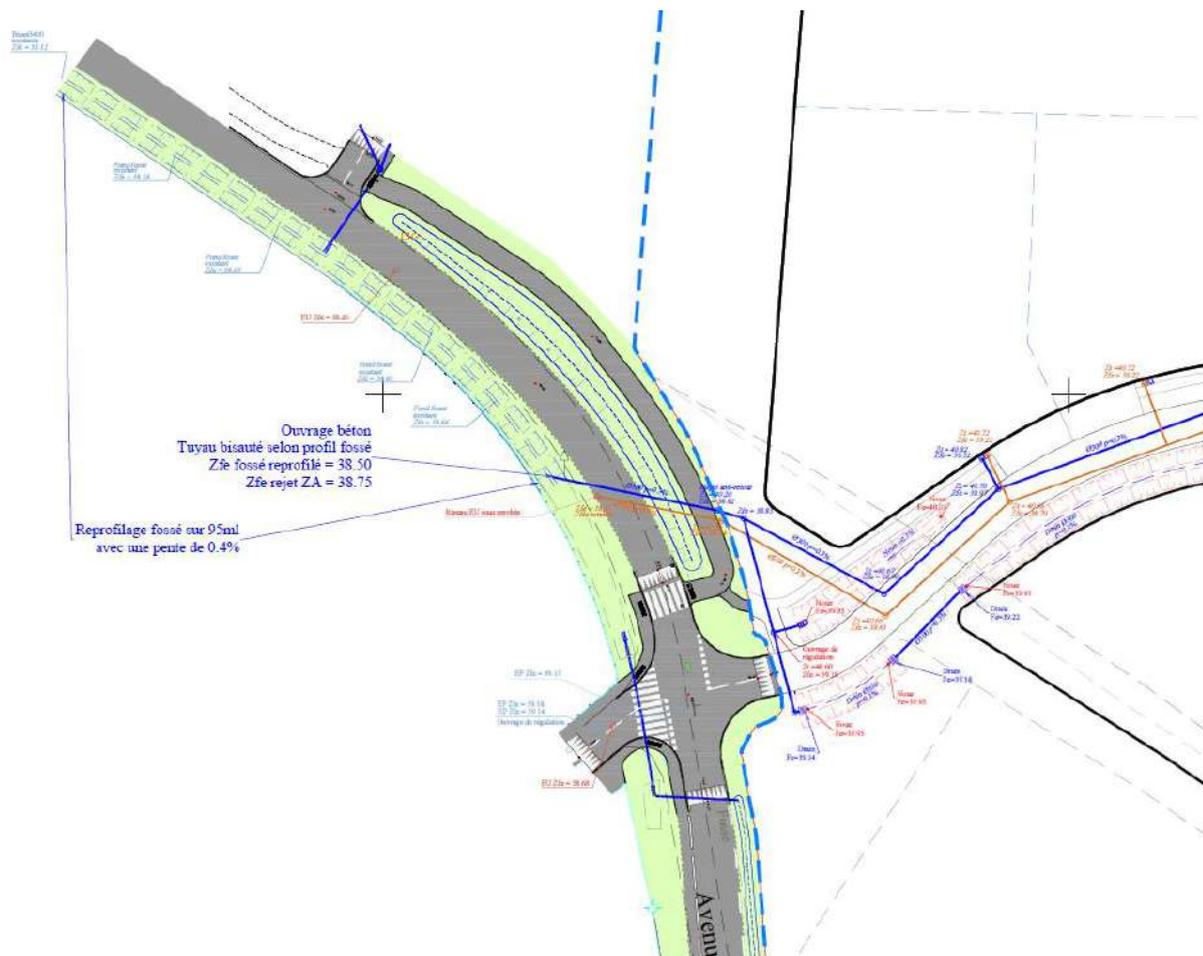
Figure 104 : Plan de raccordement du réseau d'assainissement sur le domaine public
