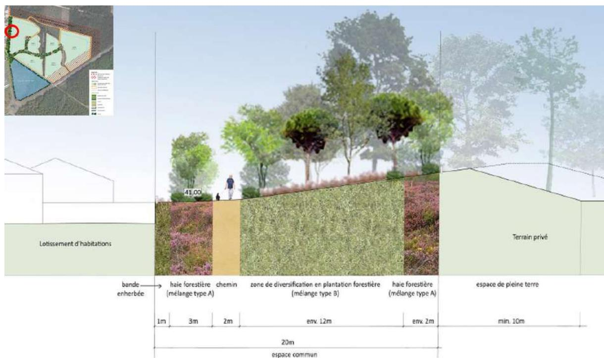
**Figure 18 : Coupe bande de 20 m en limite Ouest du projet**
