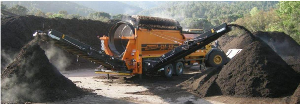
Ces refus de criblage de compost sont actuellement stockés sur aire bétonnée, et réutilisés en tête de process (mise en andain pour compostage). Au terme de ce processus, la totalité des refus de criblage de compost sont transformés en compost valorisable.
