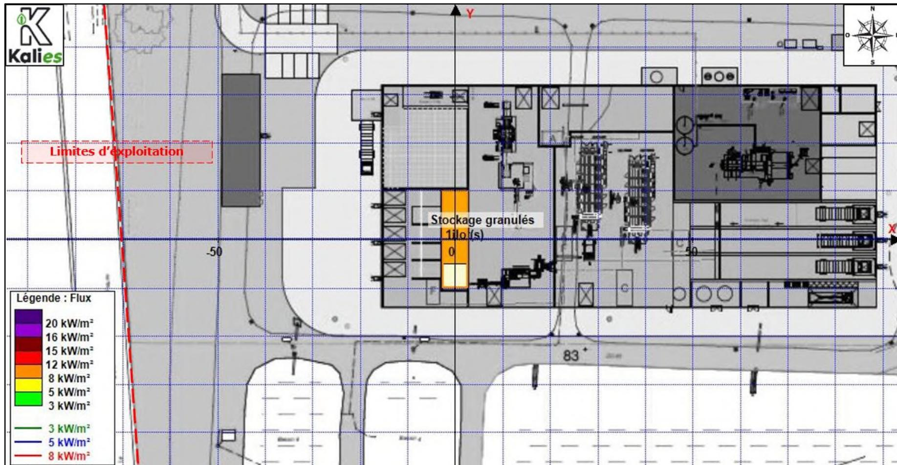
Nota : l'îlot de stockage de granulés de biofertilisant sec a été accolé à la façade nord de la cellule dans le cadre d'une approche majorante.
