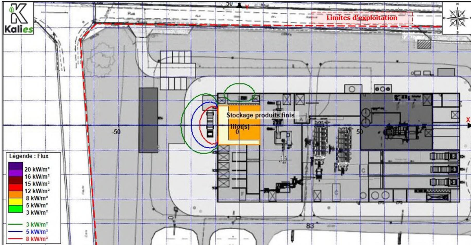
Nota : le logiciel Flumilog ne permet pas de choisir le positionnement de l'ouverture. En réalité, celle-ci sera en haut de la paroi ouest du stockage.
