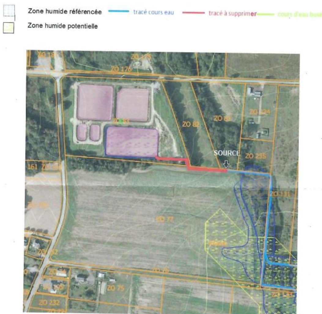
Figure n°15. Nouveau tracé du cours d'eau (source : DDTM56)
