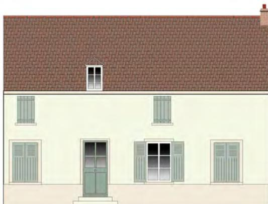
La typologie qui domine dans le centre ancien de Nanteuil est celle de la « maison rurale » (1). Il s'agit d'une construction dont la volumétrie est un simple parallélépipède rectangle surmonté d'un toit à deux pans d'environ 35 à 50°. Conçue pour être accolée, ce type de maison est souvent étroit (sa largeur sur rue ne dépasse souvent pas 5 m). Sa profondeur excède rarement 8 m. Mais le volume principal se prolonge souvent côté cour par un volume plus petit en retour.
