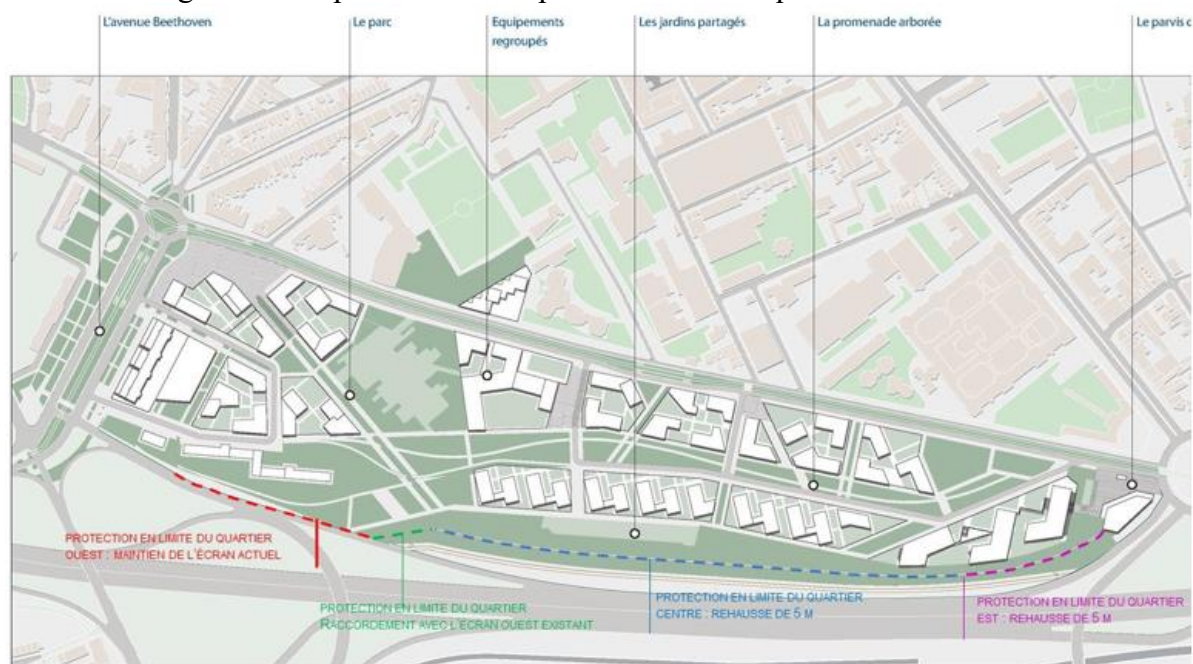
Figure 22 : implantation de la protection acoustique – solution retenue
