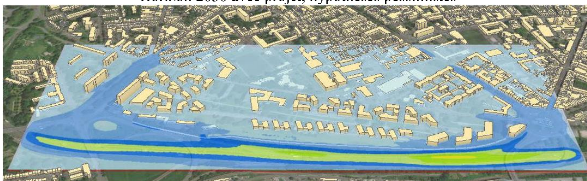
Figure 20 : carte des concentrations moyennes annuelles en NO 2 à 7 mètres du sol – Horizon 2030 avec projet, hypothèses pessimistes
