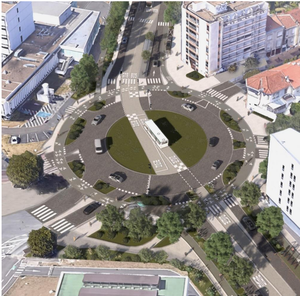
Figure 27: Exemple de giratoire percé à priorité bus
