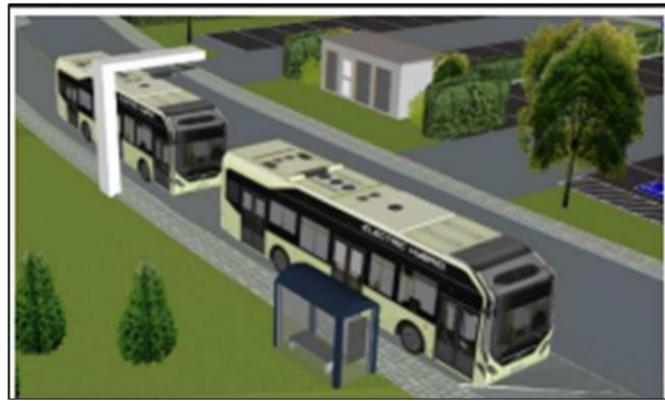
Figure 111 : Exemple de charge semi rapide au terminus. Photo non contractuelle
