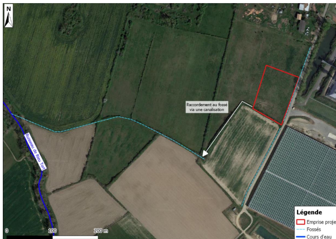
Figure 28 : Rejet des eaux pluviales du projet (Source : BD TOPAGE)
