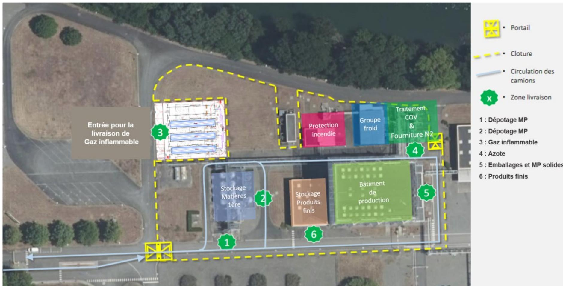
Figure 4 : Les principales installations du projet IPSOPHENE
