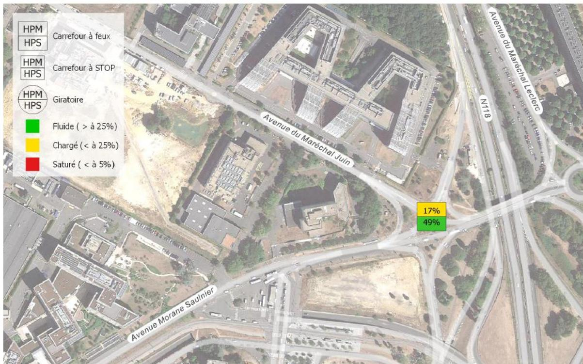
Figure 52 : Situation actuelle, réserve de capacité des carrefours
