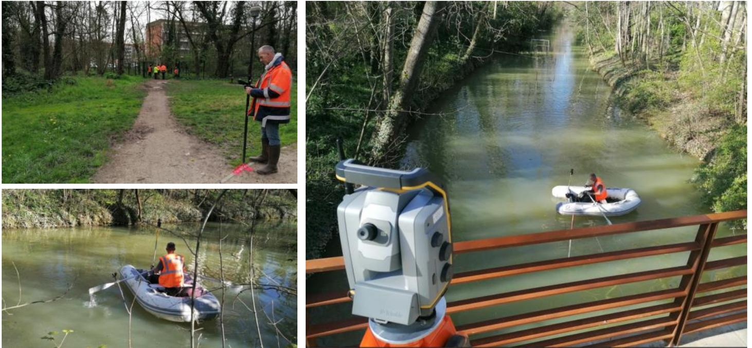
Figure 5 : Photographies des acquisitions topographiques et bathymétriques – mars 2020 - Hekladonia
