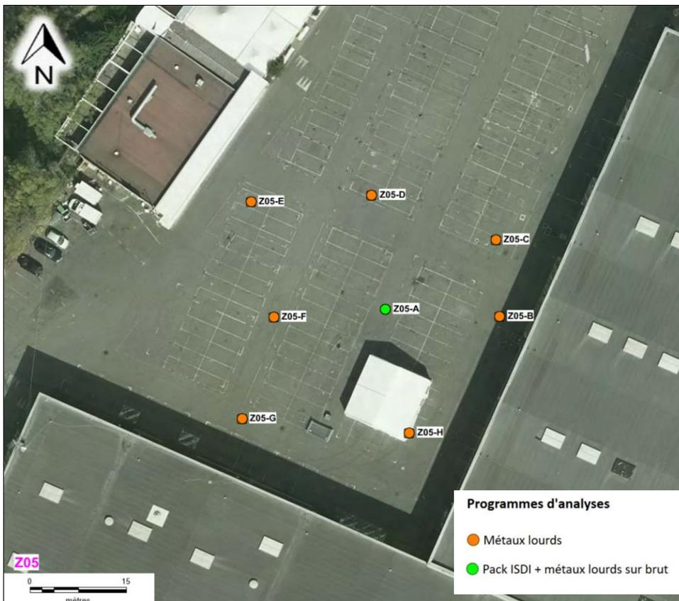
Figure 8 : Z05 – Sondages et programme d'analyses
