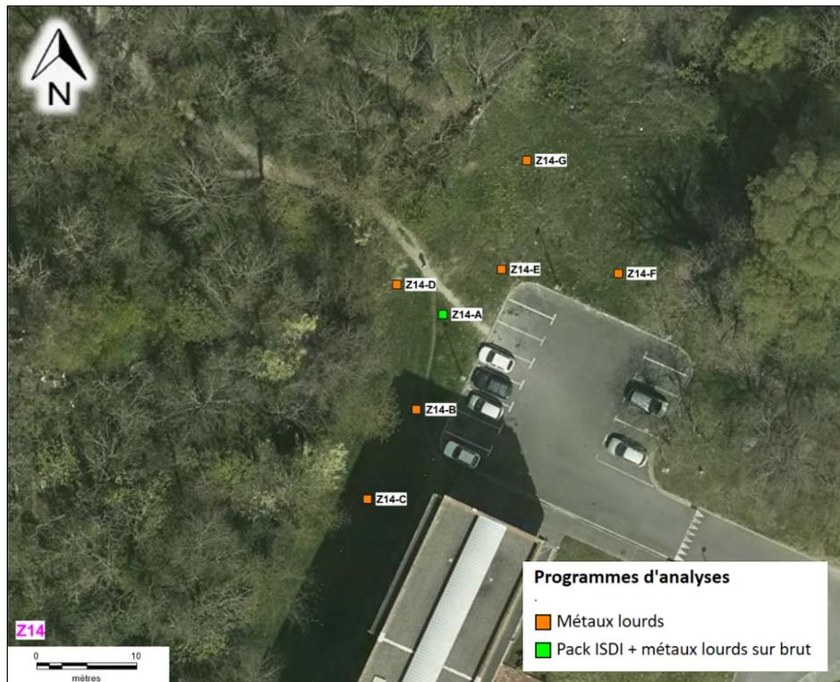
Figure 15 : Z14 – Sondages et programme d'analyses
