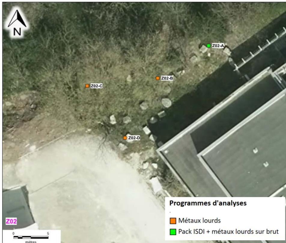
Figure 11 : Z02 – Sondages et programme d'analyses
