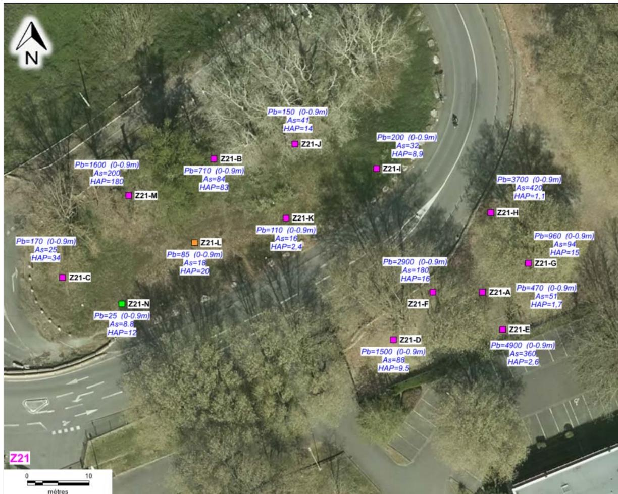
Figure 27 : Z21 – Concentrations en plomb et en HAP (mg/kg MS)
