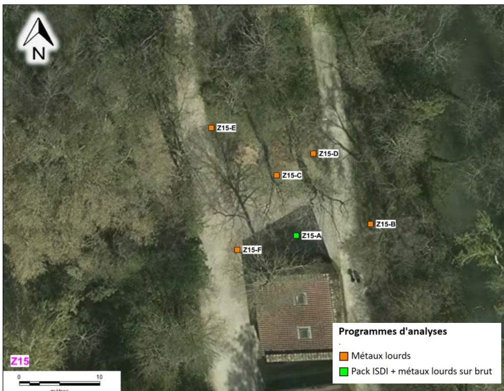
Figure 16 : Z15 – Sondages et programme d'analyses
