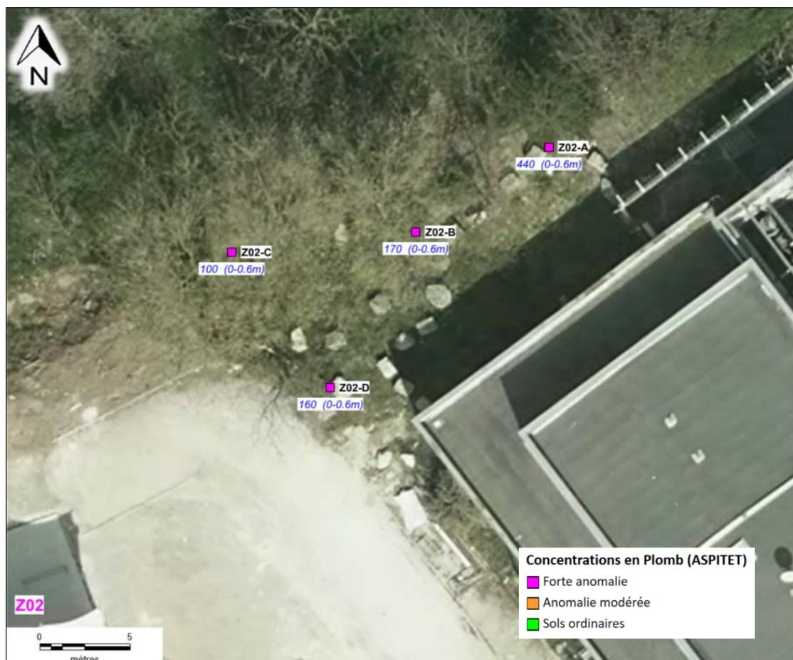
Figure 20 : Z02 – Concentrations en plomb (mg/kg MS)
