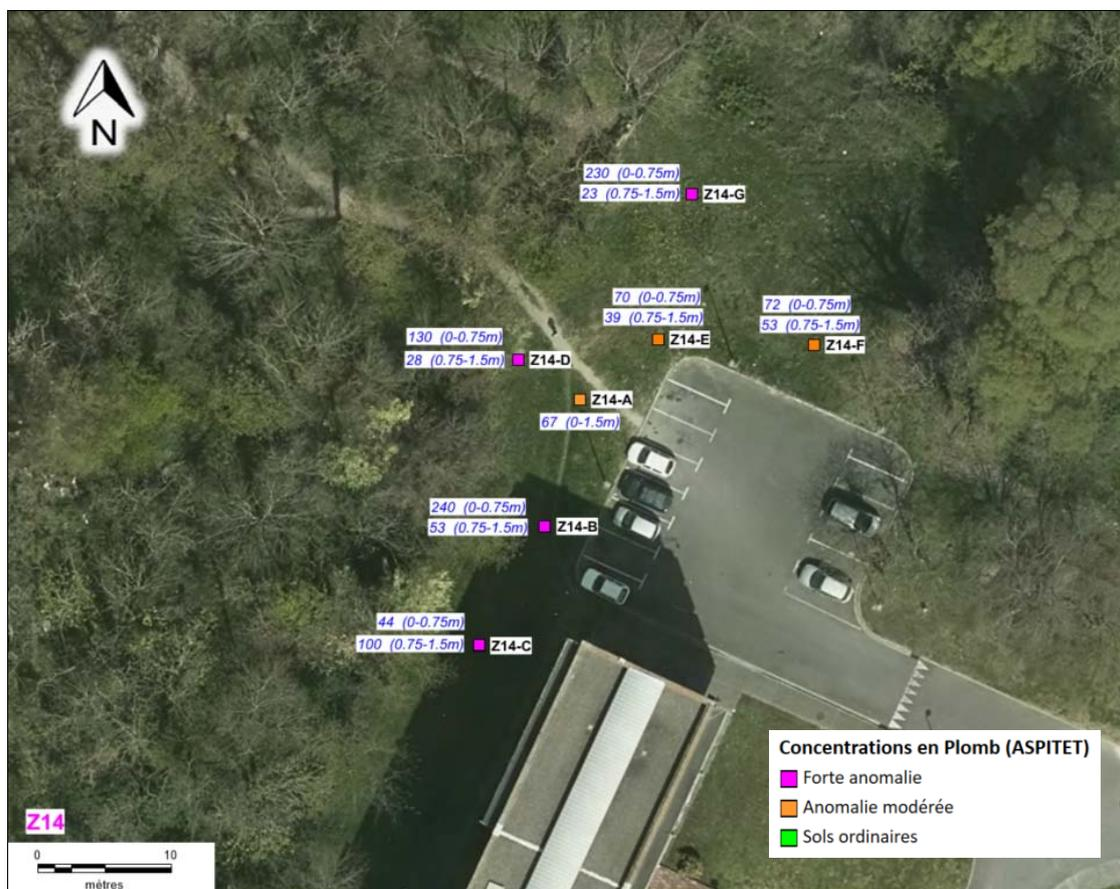
Figure 24 : Z14 – Concentrations en plomb (mg/kg MS)
