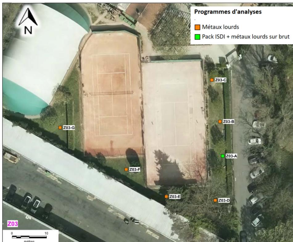
Figure 12 : Z03 – Sondages et programme d'analyses
