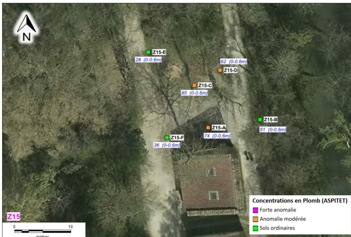
Figure 25 : Z15 – Concentrations en plomb (mg/kg MS)
