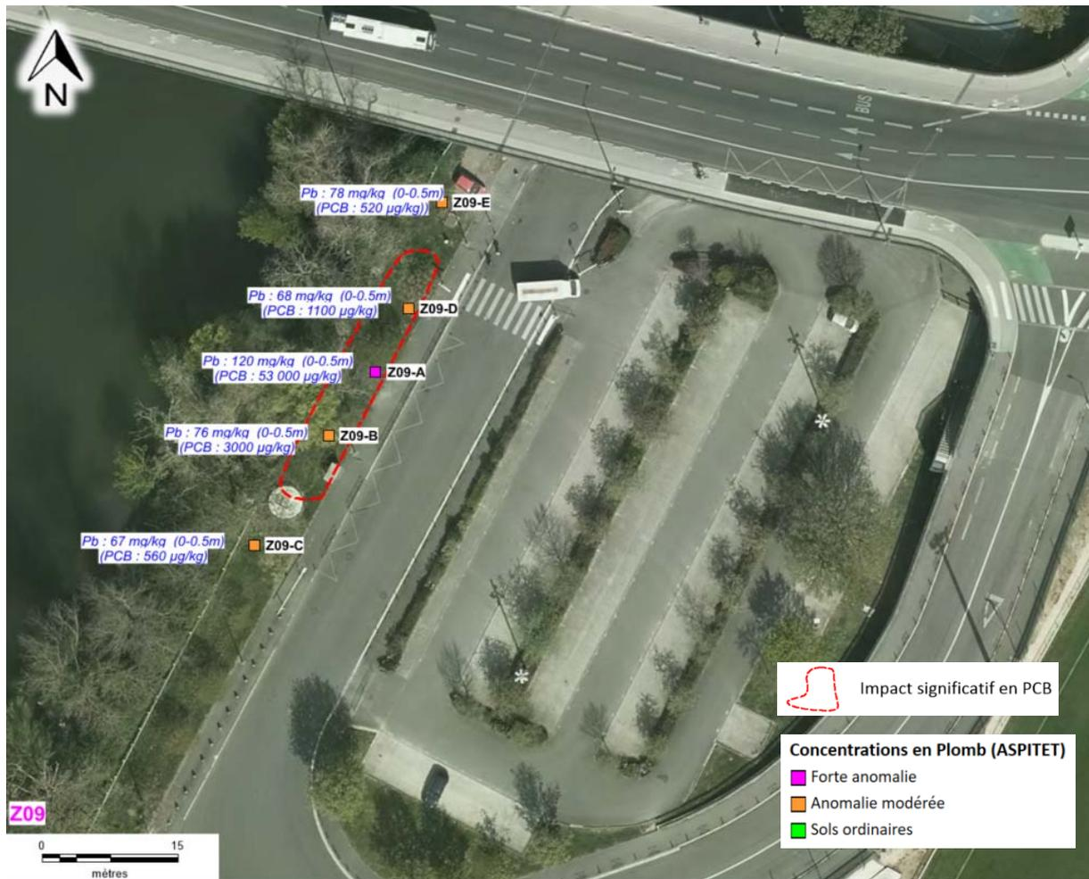
Figure 22 : Z09 – Concentrations en plomb (mg/kg MS) et en PCB (µg/kg MS)
