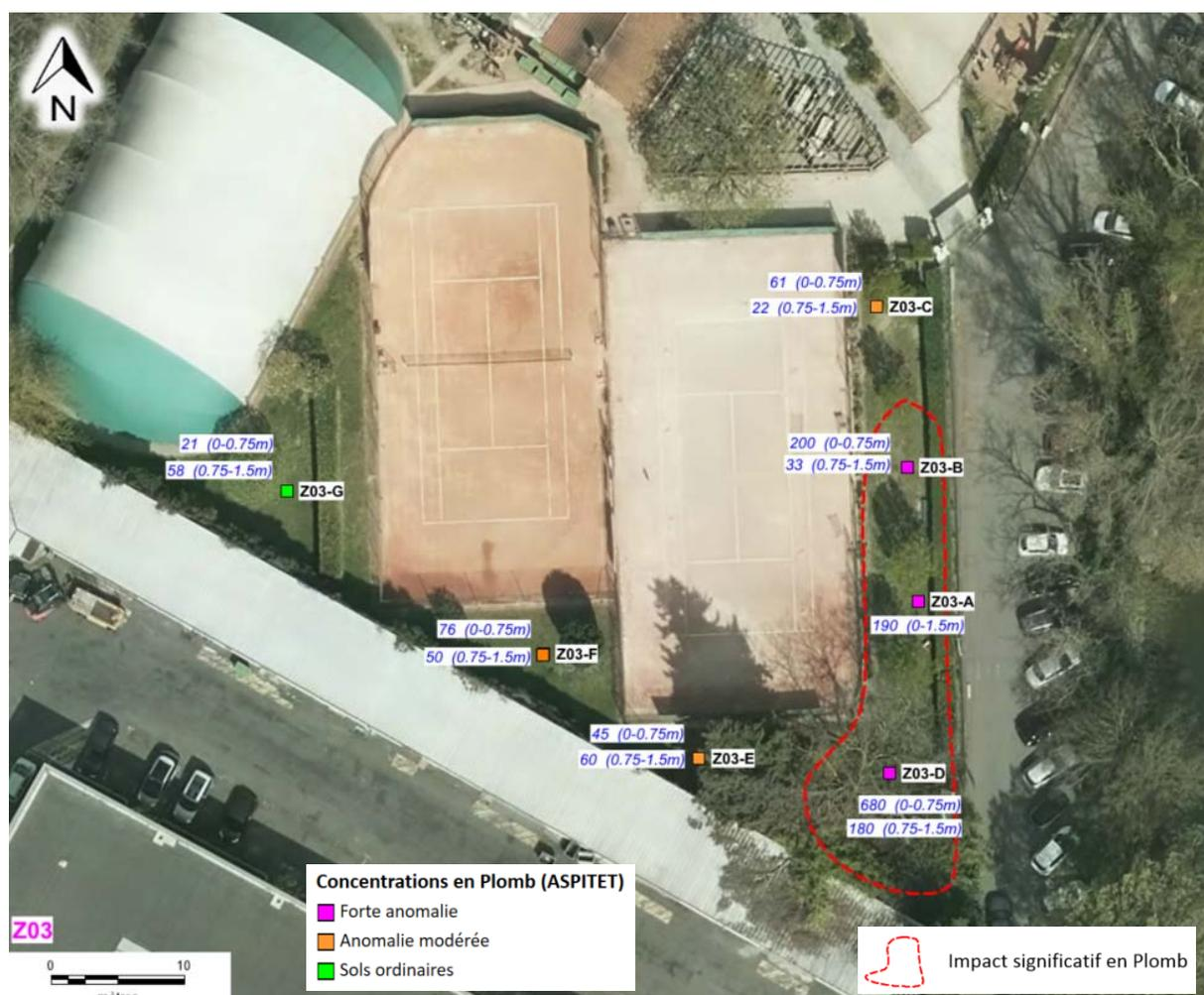
Figure 21 : Z03 – Concentrations en plomb (mg/kg MS)
