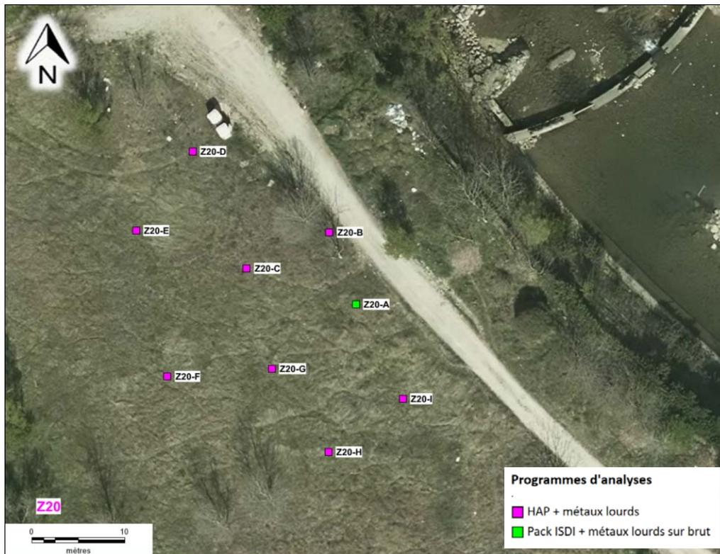
Figure 17 : Z20 – Sondages et programme d'analyses
