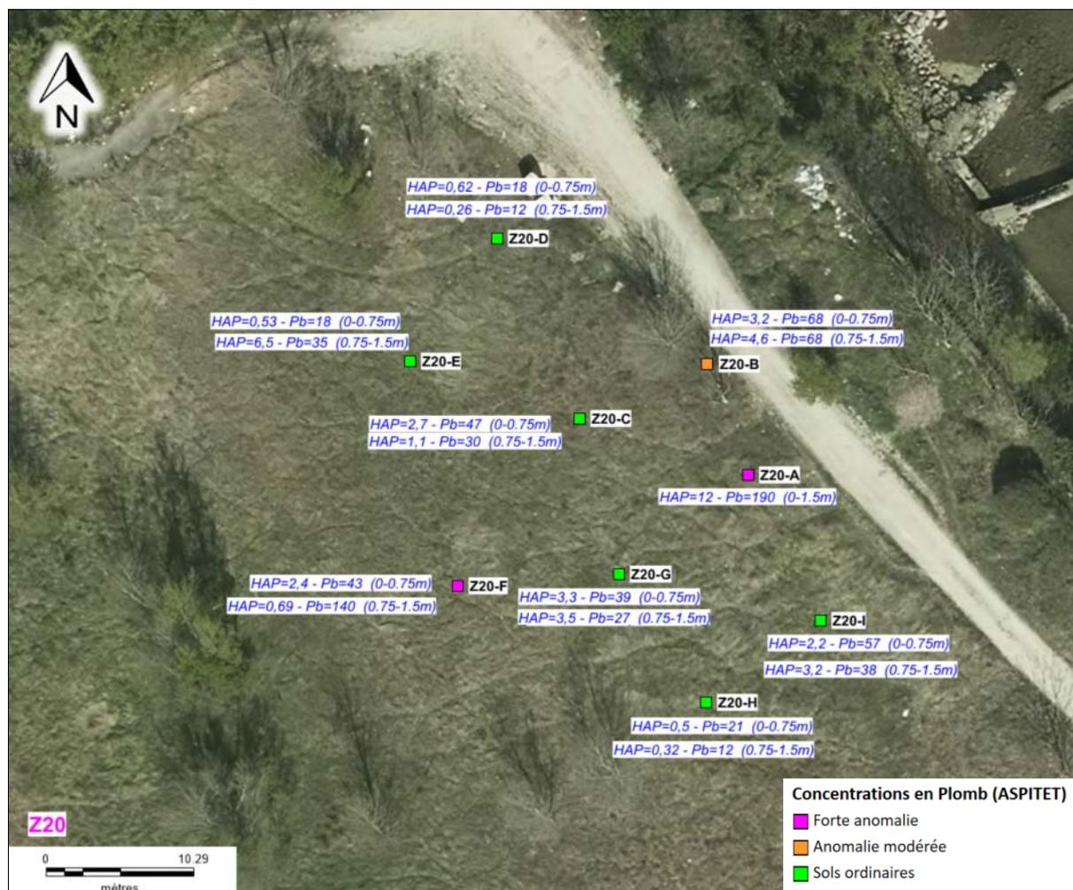
Figure 26 : Z20 – Concentrations en plomb et en HAP (mg/kg MS)
