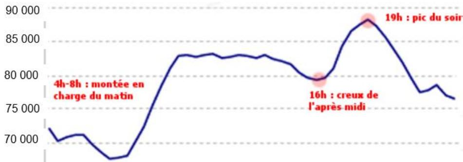
Figure 21 : Exemple de courbe de consommation électrique française journalière en hiver (source : RTE)
