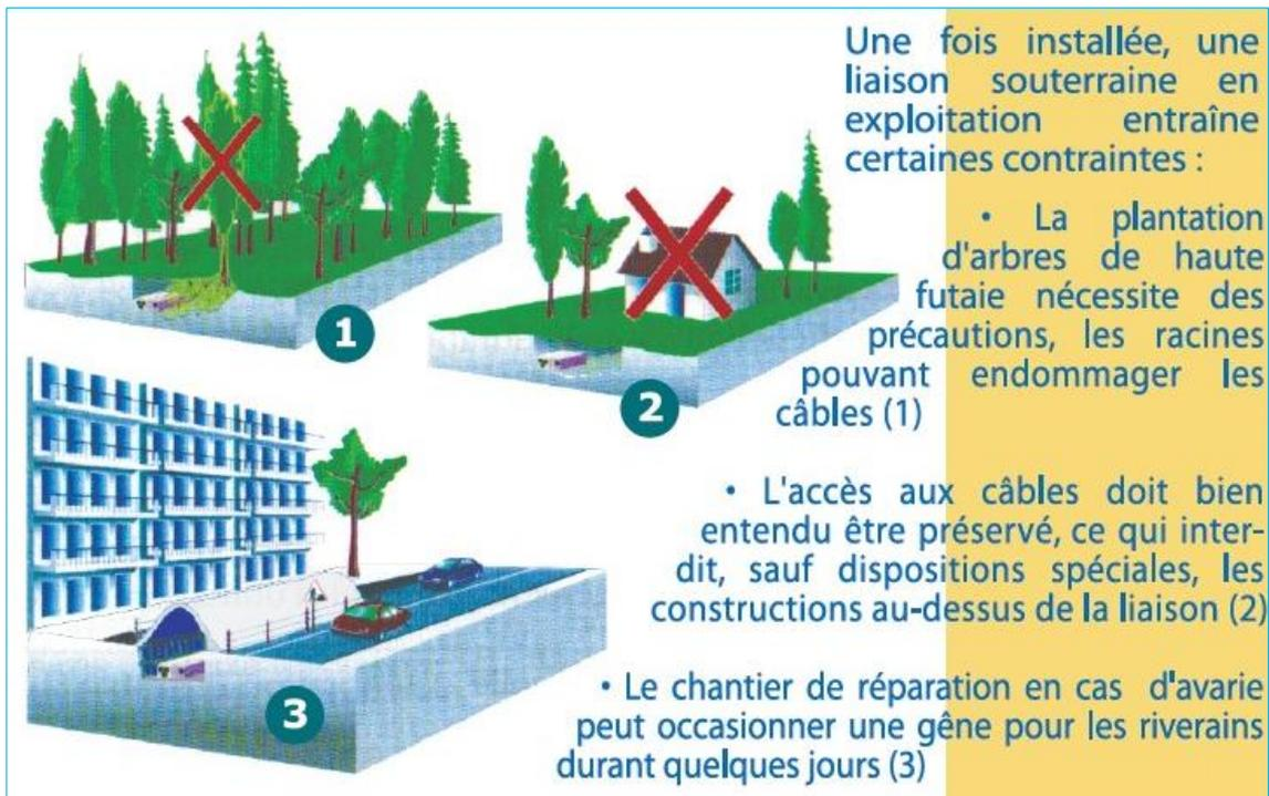
Figure 10 : Contraintes inhérentes au câble électrique souterrain (source : RTE, 2021)
