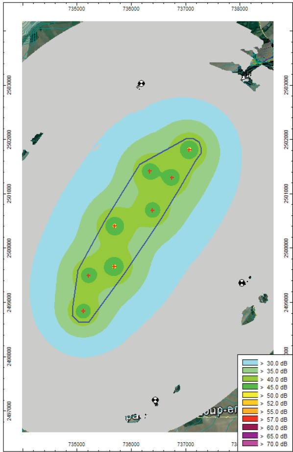
Carte sonore prévisionnelle des niveaux de bruit en limites de propriété du parc éolien
