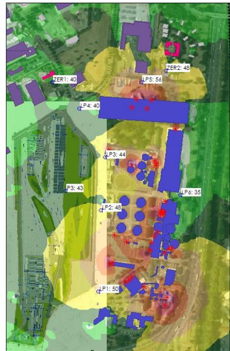
**Figure n°2. Impact sonore futur évalué pour le projet (Entrées d'air et rejet 85 dB(A) à 1m)**
