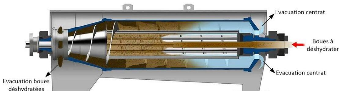
Les centrifugeuses seront installées dans un local insonorisé. Le lavage des centrifugeuses sera effectué avec de l'eau industrielle. Les centrats et les eaux de lavage seront envoyés vers le réseau des retours en tête de la zone (vers la file G1 ou la file G3).
