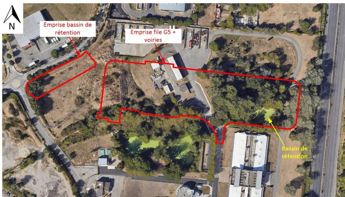
La mise en œuvre de la filière de traitement du phosphore se fera au niveau de l'emplacement de la file G2 dont les ouvrages seront démolis après mise en service de la file G5.
