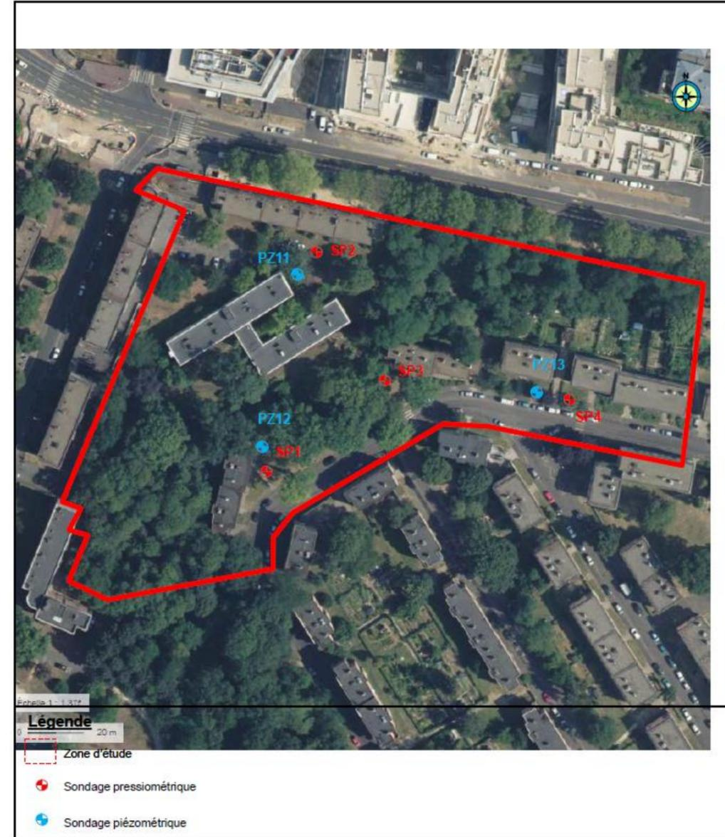
Figure 15 : Plan d'implantation des sondages sur l'îlot Les Escaliers (Source : Etude géotechnique G2-AVP, Géolia)
