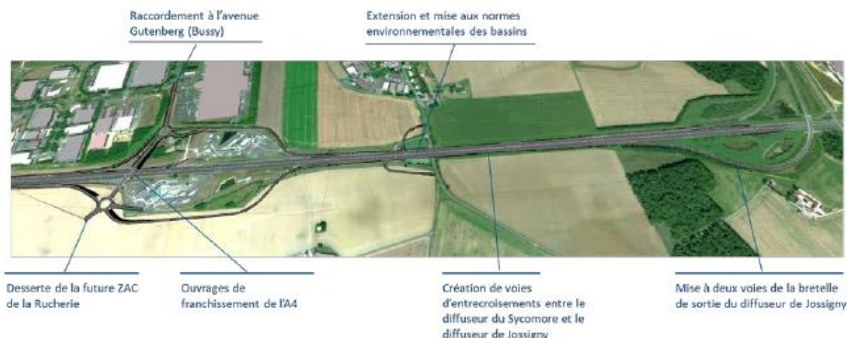
Figure 18 : Synoptique de l'aménagement du diffuseur (Maquette BIM) - Source : Étude d'impact
