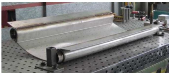
Figure 19 : Échangeur installé dans un ovoïde existant (Rabtherm), échangeur pour collecteur existant (Uhrig)
