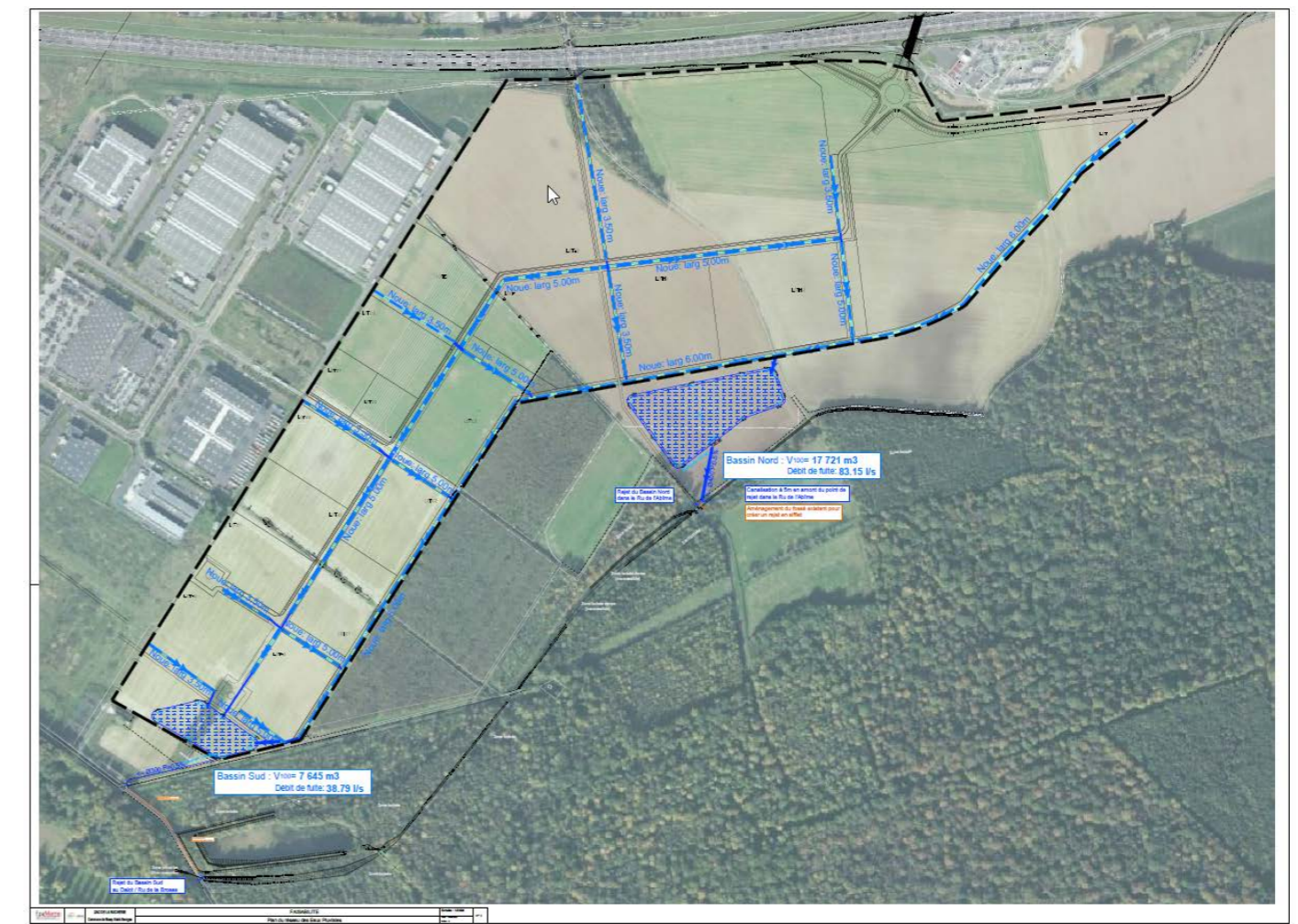
Figure 8 : Schéma du principe d'assainissement des eaux pluviales de la ZAC de la Rucherie (source : Urbatec)
