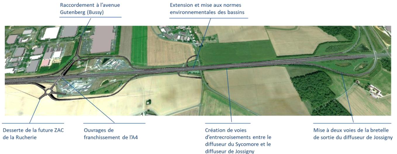
Figure 5 : Synoptique de l'aménagement du diffuseur (maquette BIM)
