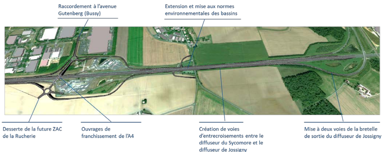
Figure 5 : Synoptique de l'aménagement du diffuseur (maquette BIM)
