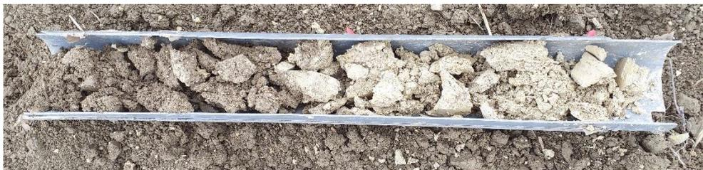
**Figure 7 :** Sondage N°1 réalisé par Biotope en Octobre 2020. Caractéristique de zones humides.
