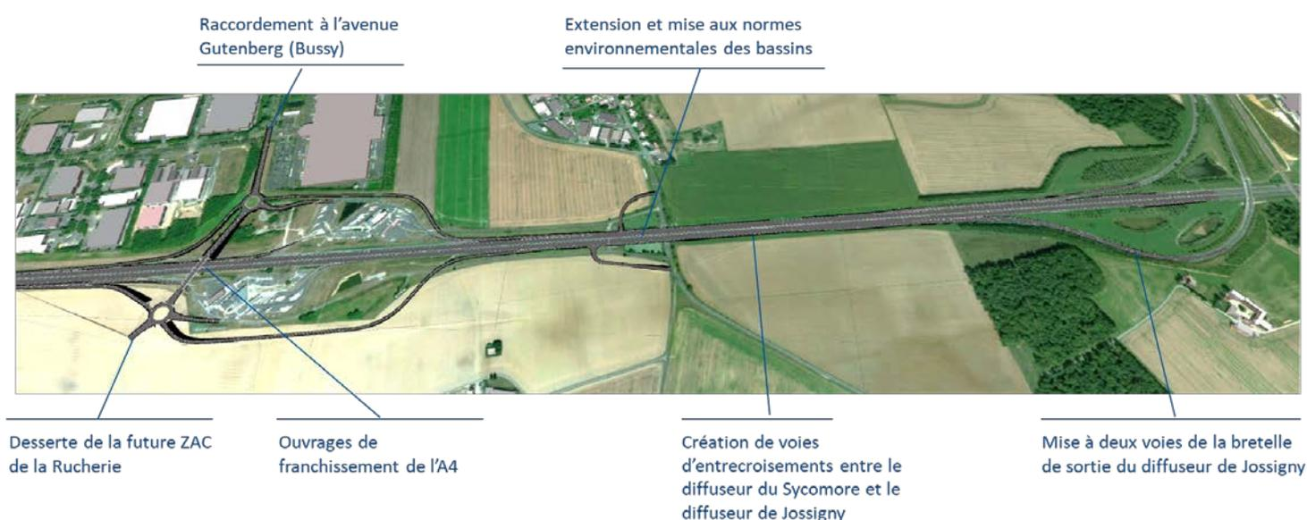
Figure 11 : Synoptique de l'aménagement du diffuseur (maquette BIM)
