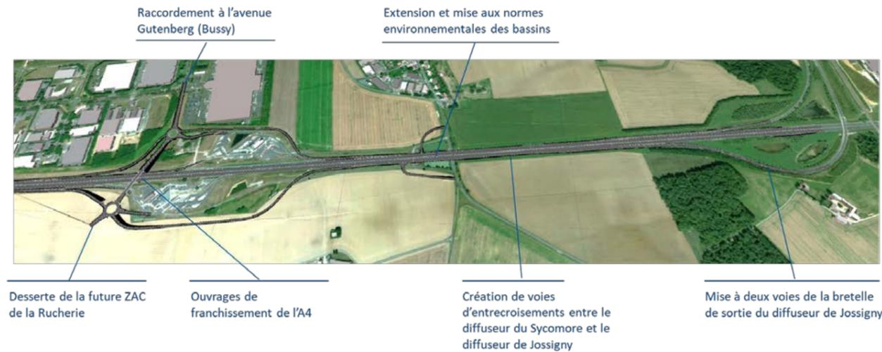
Figure 3 : Synoptique de l'aménagement du diffuseur (maquette BIM)
