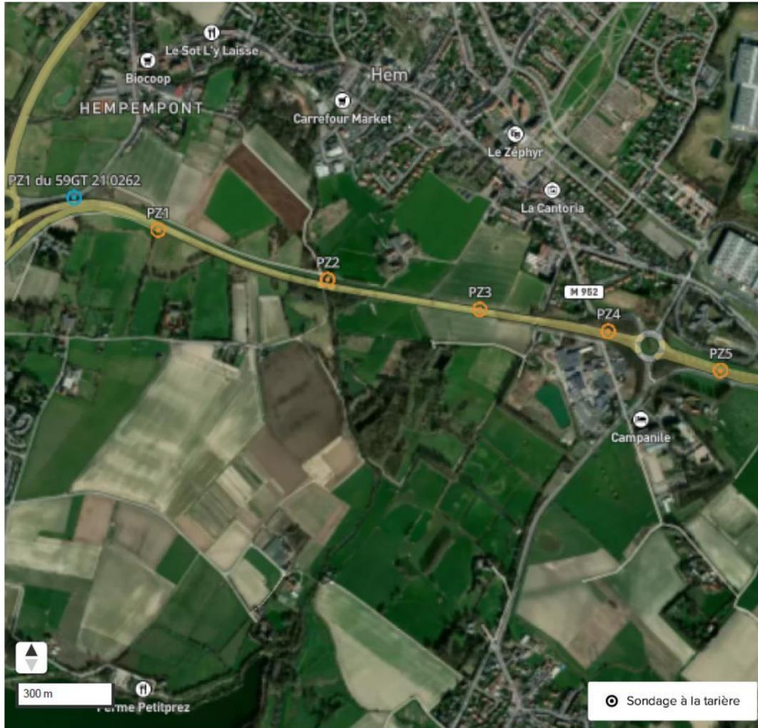
Figure 12 : Plan d'implantation des sondages (Source : Fondasol)
