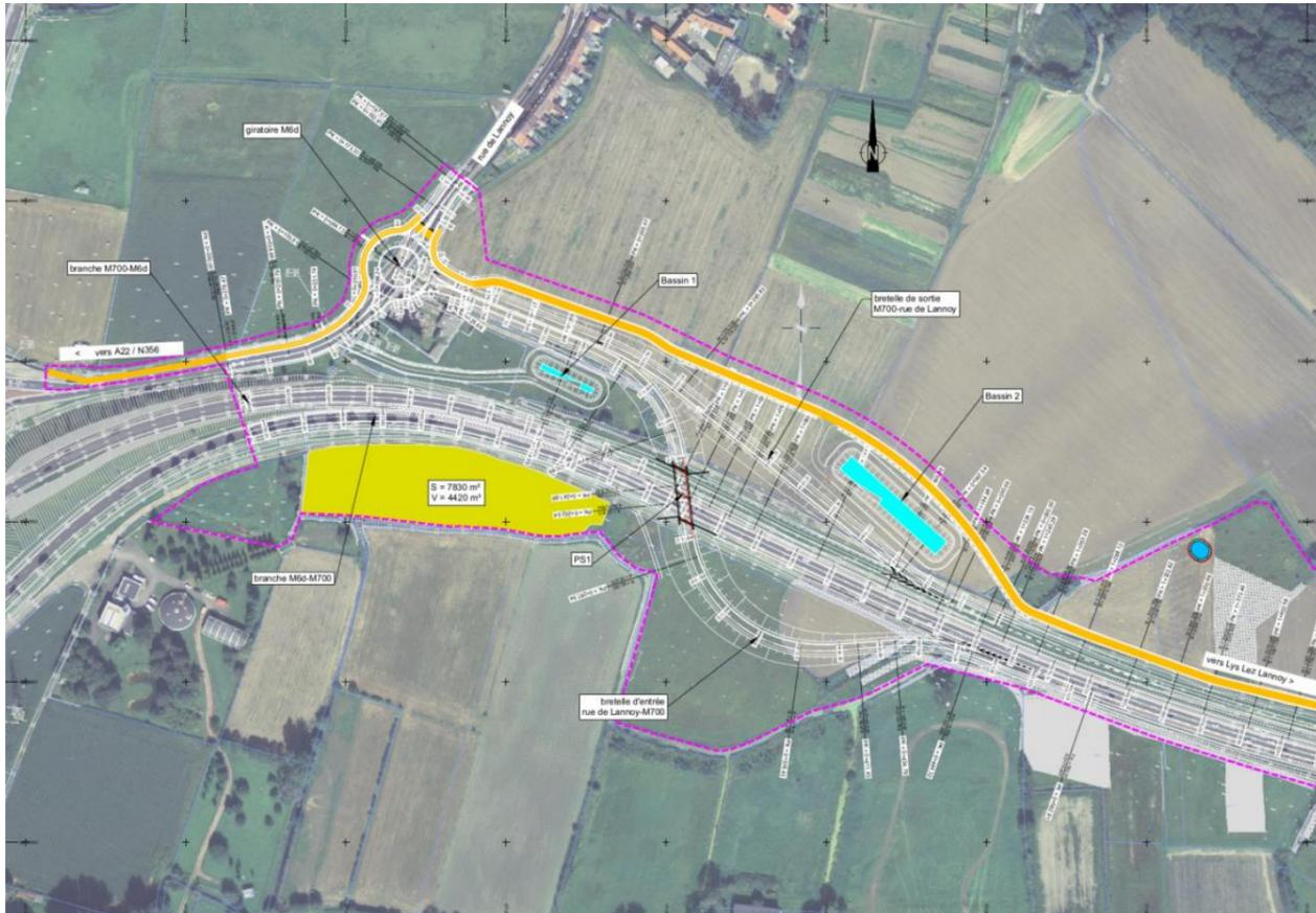
Figure 54 – Vue en plan de la M700 au niveau de la bretelle d'accès à la M6d
