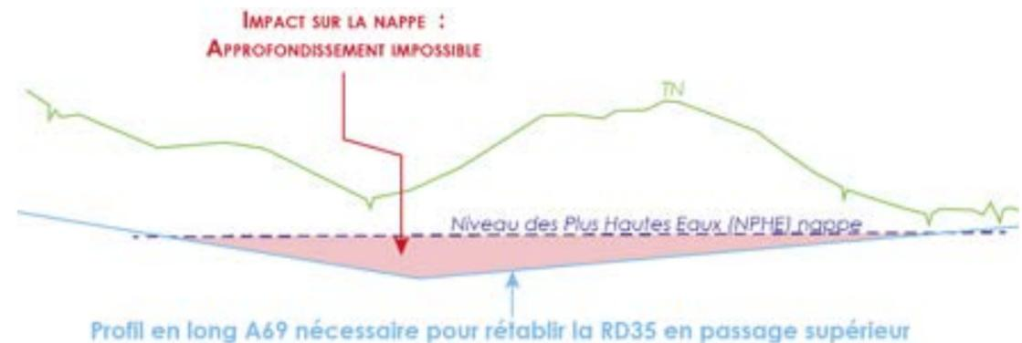
Illustration 22 : Profil en long A69 nécessaire pour rétablir la RD35 en passage supérieur, GCC
