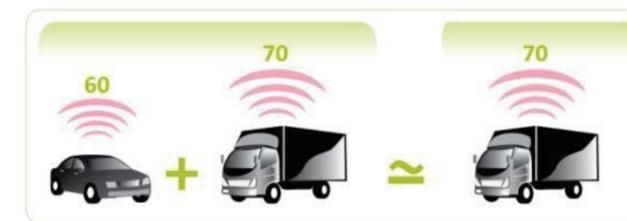
Figure 5 : Deux sources d'intensité différente, Source Egis
