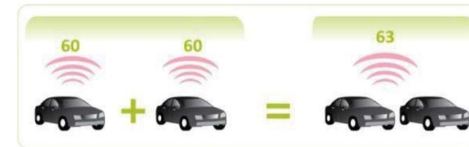
Figure 4 : Doublement de l'intensité, Source Egis
