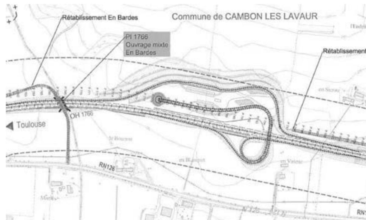
Cette solution permet de dégager un volume brut de déblais de 770 000 m<sup>3</sup>. Elle nécessitait la création d'un ouvrage d'art.
