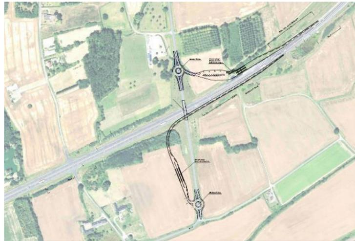
Figure 8 : Variante avec entrée en boucle (configuration mixte)
