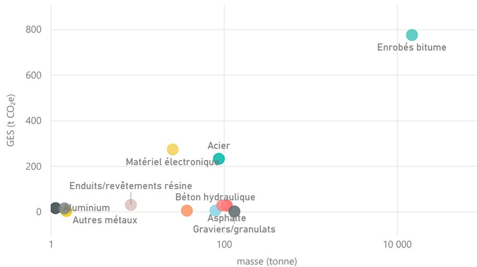
TABLEAU 1.7 – Utilisation des matériaux et leur contenu carbone en phase Construction [C] et Maintenance [M]
