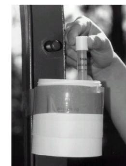
Figure 53 : Exemple d'installation des tubes pour le dioxyde d'azote
