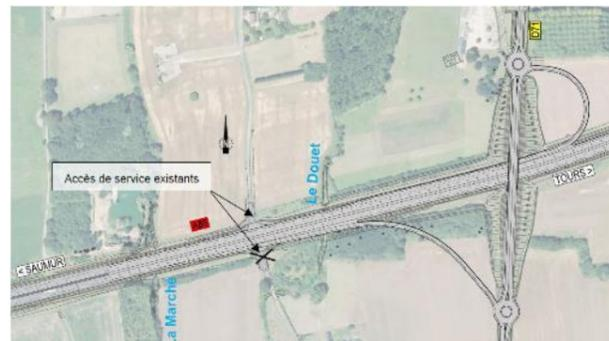
Variante avec entrée en boucle (configuration mixte)
