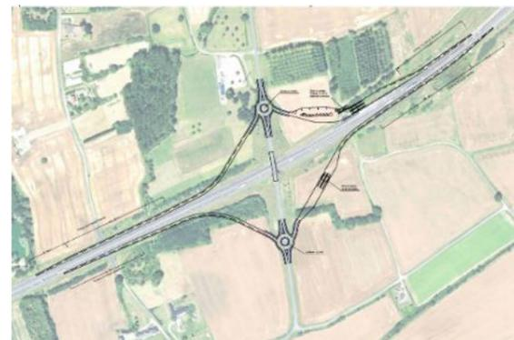
Exemple de diffuseur en losange
