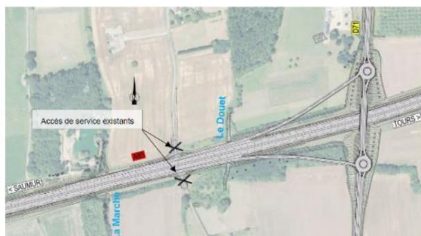
Solution demi-diffuseur Restigné Ouest (configuration en losange)
