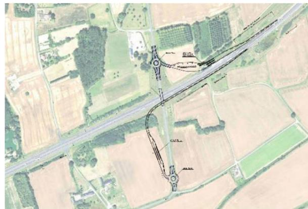
Variante avec entrée en boucle (configuration mixte)
