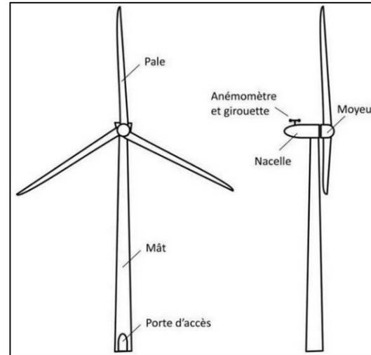
Figure 1 : Schéma simplifié d'une éolienne
