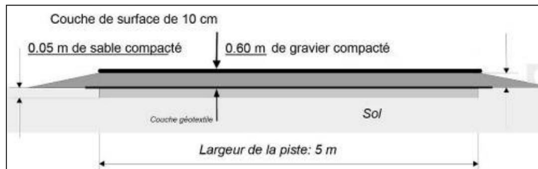
Figure 11 : Coupe transversale d'une piste d'accès
