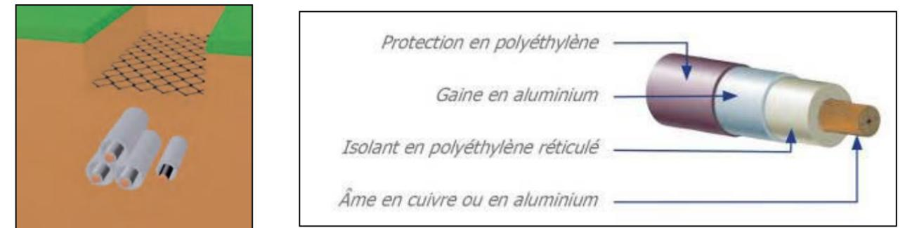
Figure 13 : Principe d'enfouissement et coupe d'un câble de raccordement souterrain (source : RTE)
