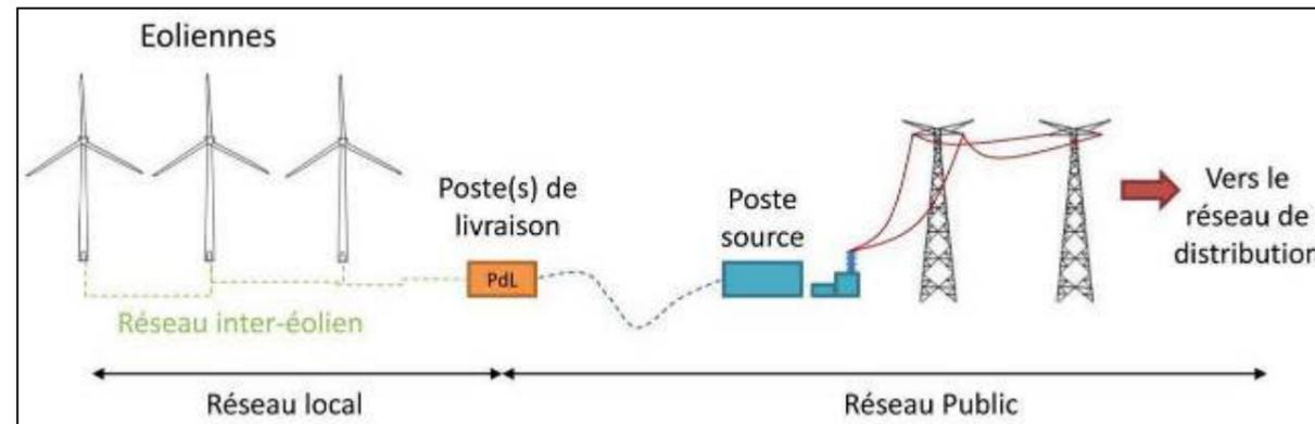
Figure 12 : Principe de raccordement électrique d'une installation éolienne (Source : Ineris)
