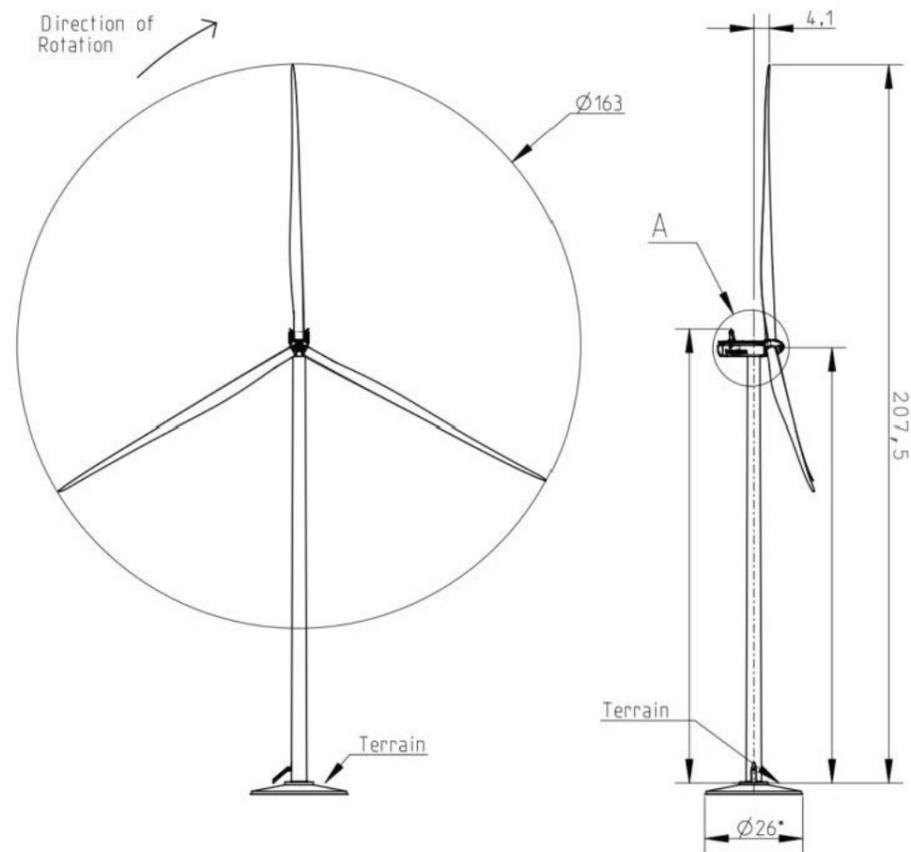
Figure 3 : Schéma du gabarit de la Vestas V163 retenu dans le cadre de la présente étude d'impact
