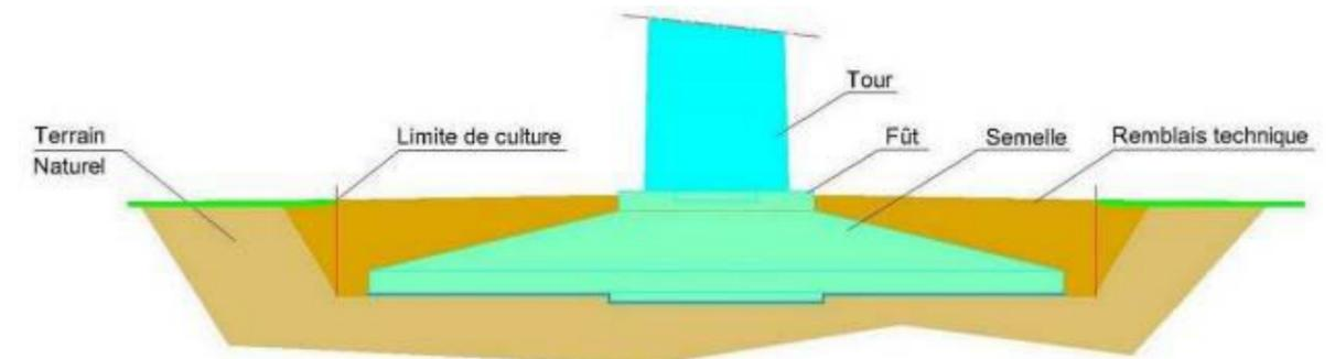
Figure 6 : Schéma type d'une fondation
