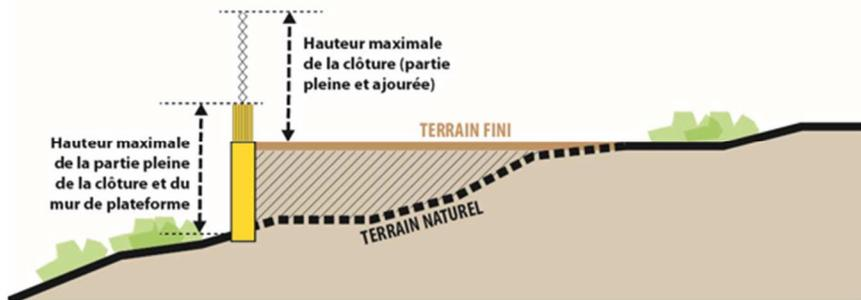
Lorsqu'une clôture surmonte un mur de plateforme\* destinés à des déblais :
