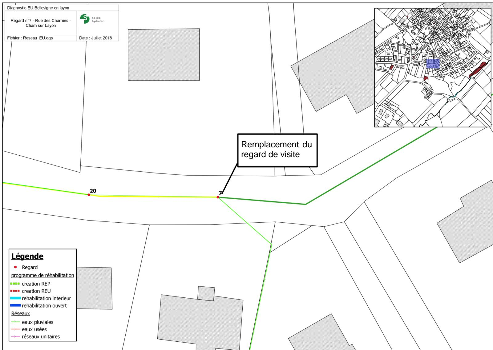
Figure 13 : Remplacement d'un regard de la rue des Charmes – Bourg de Champ-sur-Layon
