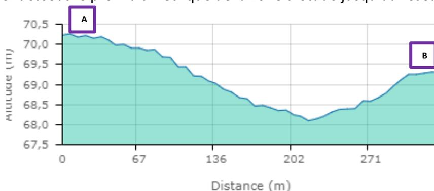
Le raccordement sur la rue du Rabelais semble envisageable, avec toutefois des aménagements spécifiques à prévoir au niveau du point bas du secteur d'étude. En effet, le réseau devra être peu profond et sera situé sur une voie de circulation. **De ce fait, il sera nécessaire de bétonner la tranchée du réseau afin de protéger la canalisation.**
