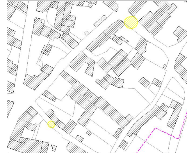
Figure 4 : Zonage au niveau de deux cavités sous voirie
