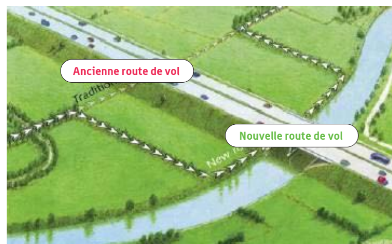
Principe de rétablissement des routes de vol des chauves-souris [d'après Limpens H.J.G.A., P. Twisk P. & G. Veenbaas, 2005]
