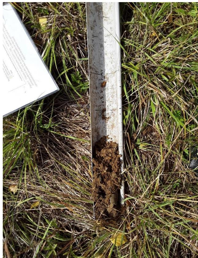
Figure 14 : Présence d'argiles avec quelques traces d'hydromorphie au sondage n°22
