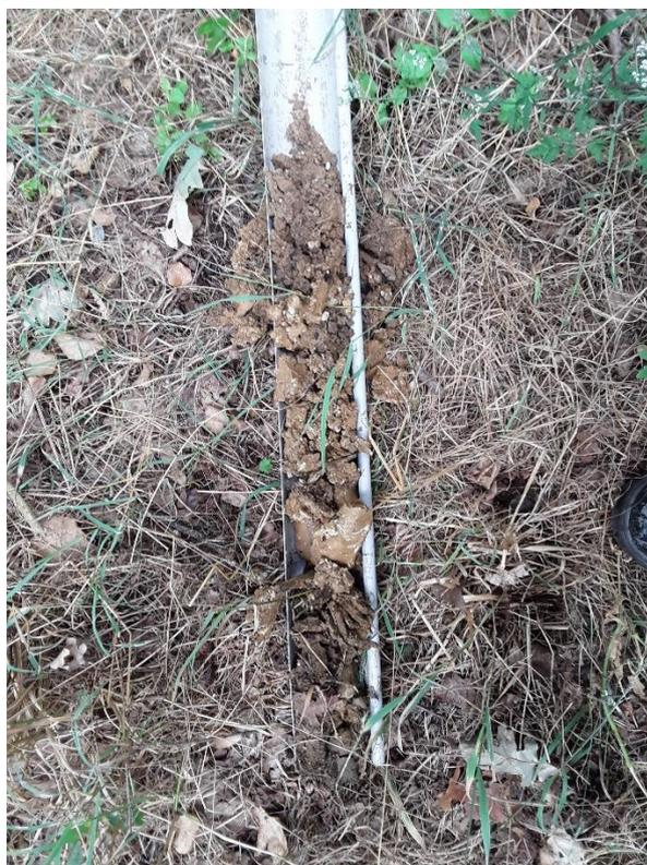
Figure 28 : Sondage n°39 présentant des carottages d'argiles
