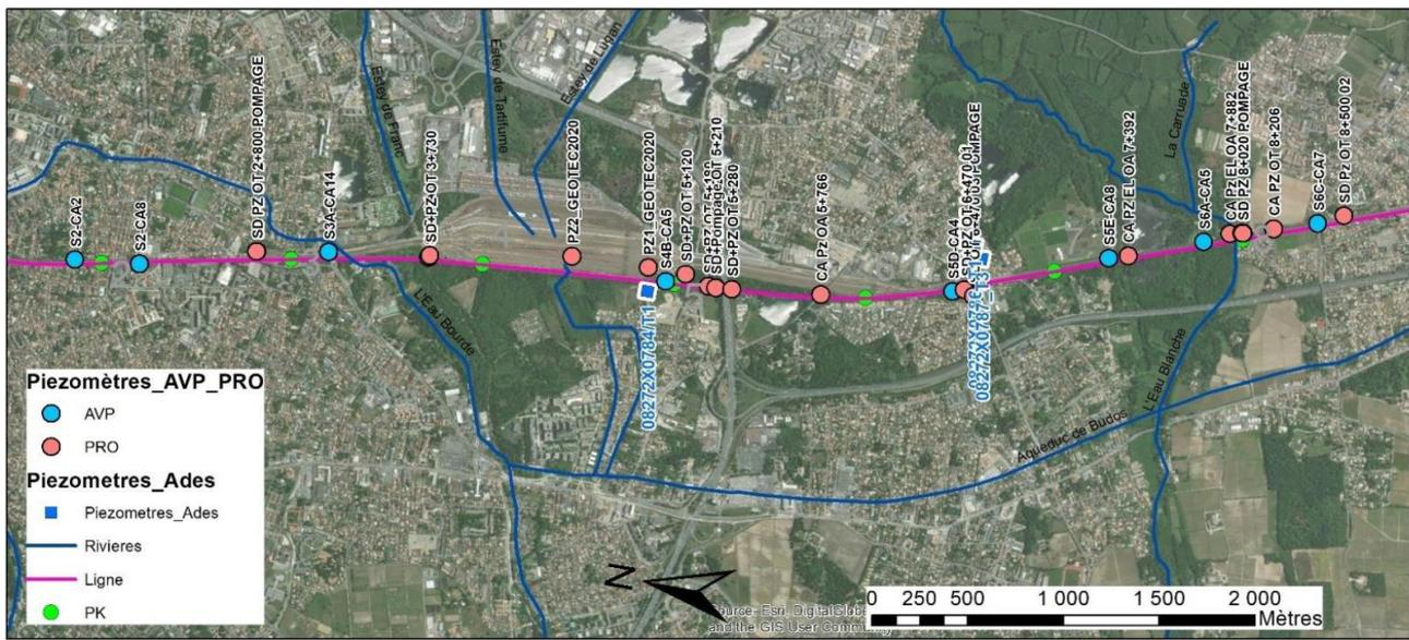
Figure 3 : Localisation des piézomètres au droit du projet sur la partie nord (jusqu'au ruisseau de l'Eau Blanche) – Source SNCF Réseau – Mars 2023
