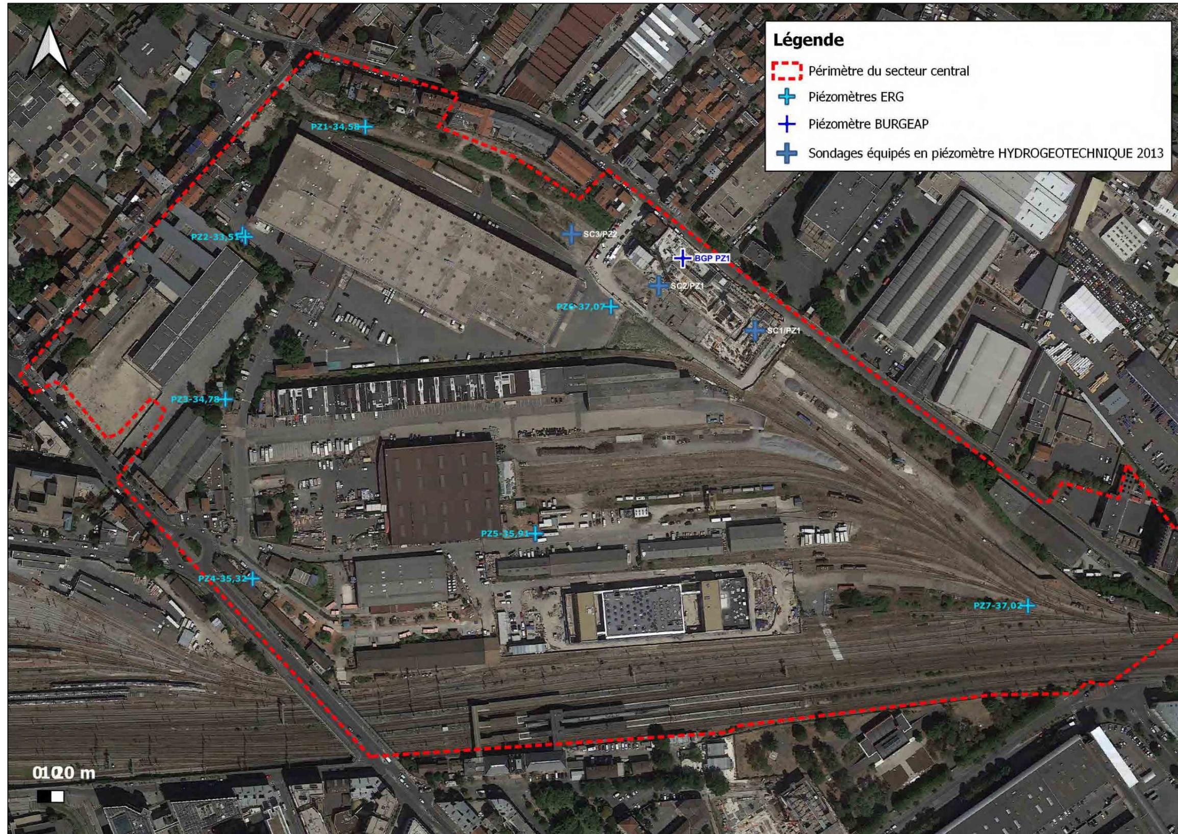
Figure 7 : Localisation des piézomètres réalisés lors des précédents diagnostics (secteur central)
