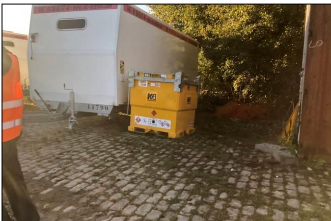
Photographie n°38 – Cuve à fuel aérienne mobile
