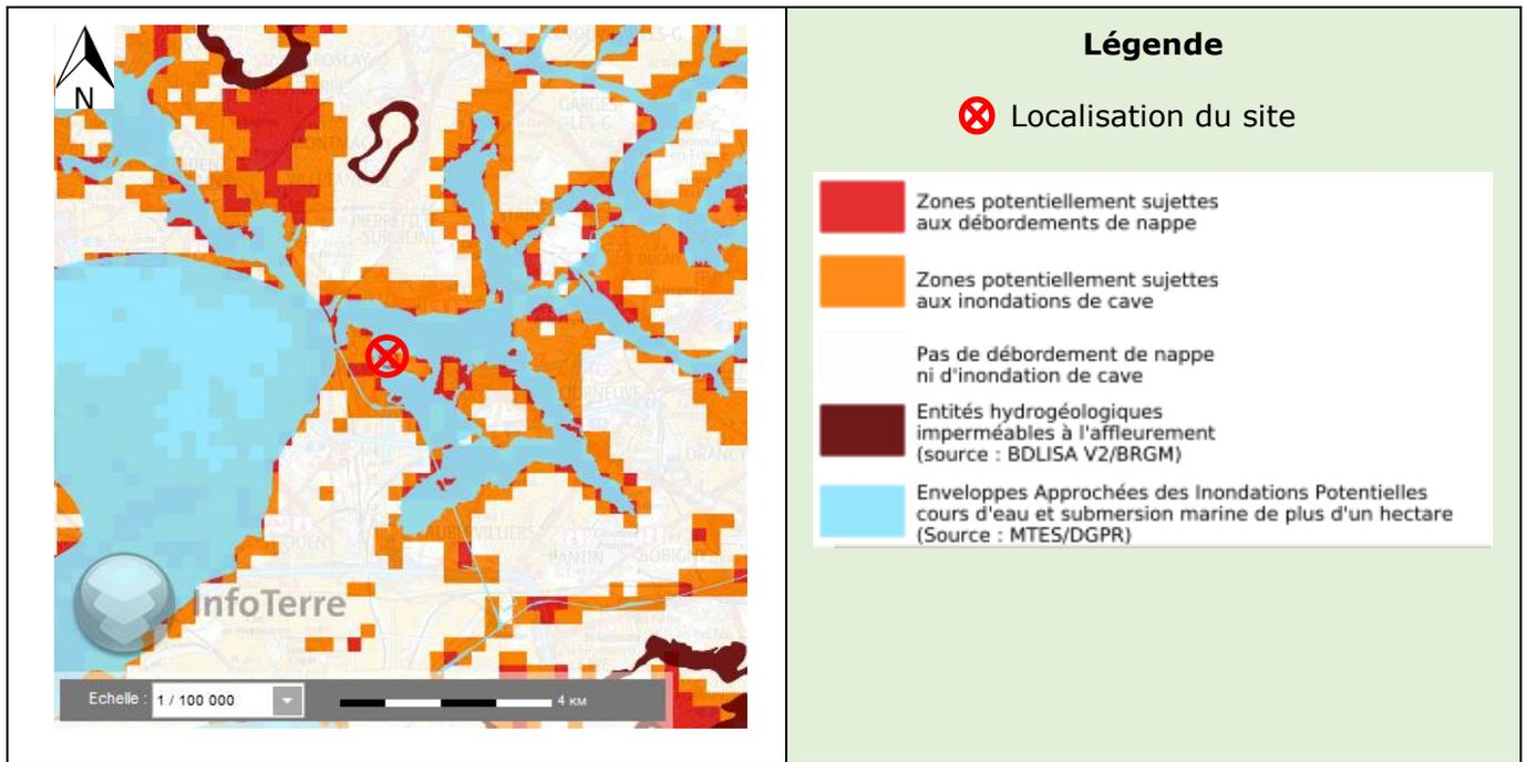
Figure 5 : Extrait de la carte des remontées de nappe (source : BRGM)
